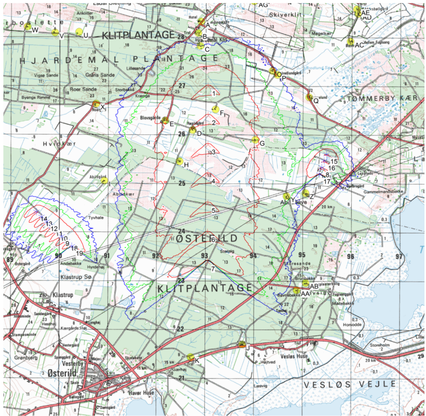
Skyggekast, Isolinier viser skygge i skyggetimer pr år. Beregnet af reel værdi.
