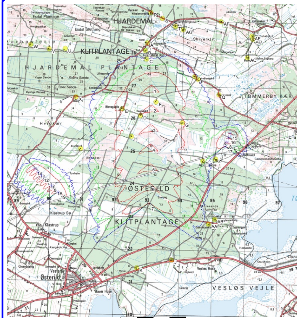
Kort: Hanstholm 1117 II, Udskriftsmålestok 1:50.000, Kortcentrum UTM ED50 Zone: 32 Øst: 493.139 Nord: 6.324.697 ▲ Ny mølle * Eksisterende mølle ☼ Skyggemodtager Isoliner viser skygge i Skyygetimer pr. år. Beregning af reel værdi. 5 10 25
